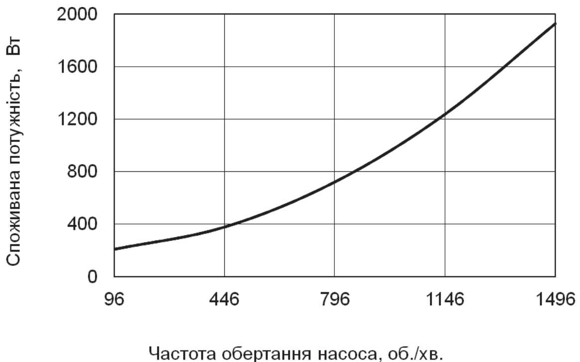
Рис. 1. Залежність споживаної потужності дискового змішувача від частоти обертання насоса
