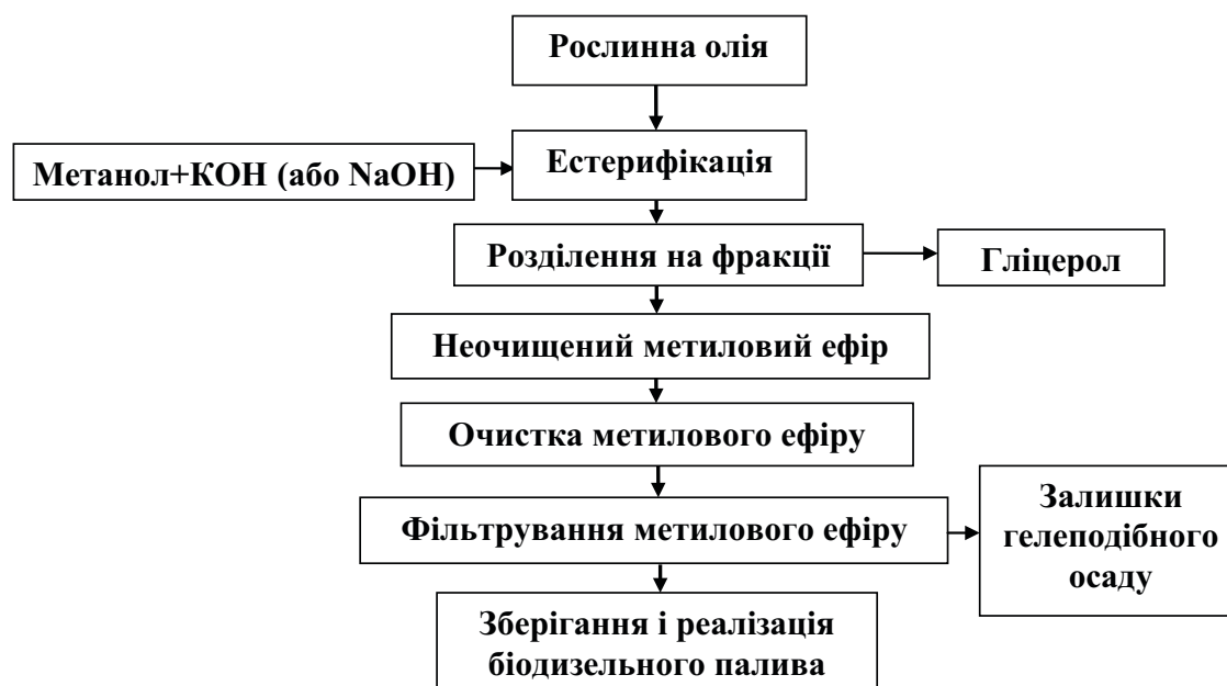
Рис. 5 Схема агропромислового виробництва дизельного біопалива
