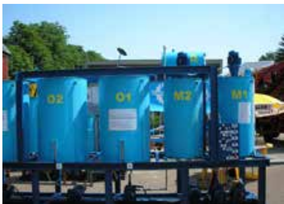
Рис. 6 Установка УВМЕ-1000 для одержання метилових ефірів з рослинних олій продуктивністю 1000 т/рік
