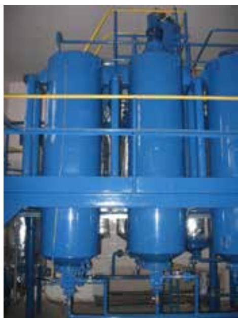
Рис. 7 Експериментальне обладнання для виробництва дизельного біопалива продуктивністю 100 л/год
