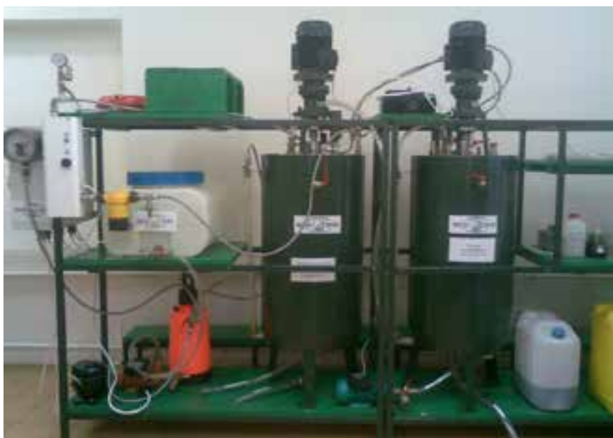
Рис. 7 Експериментальне обладнання для виробництва дизельного біопалива продуктивністю 100 л/год
