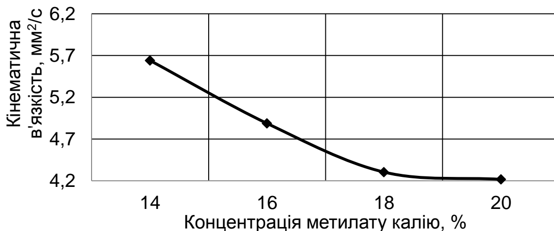
Рис. 2. Залежність кінематичної в'язкості дизельного біопалива виробленого із олії отриманої із зернового вороху від концентрації метилату калію.
