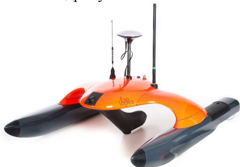
Рис 1. Безпілотний надводний апарат, модель1 Sonobot 5. Джерело: розроблено автором на основі [1].
